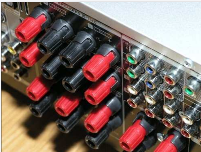
Bananenstecker-geeignete Lautsprecher-Schraubverschlüsse, wie üblich in dieser Preisklasse für alle Kanäle
