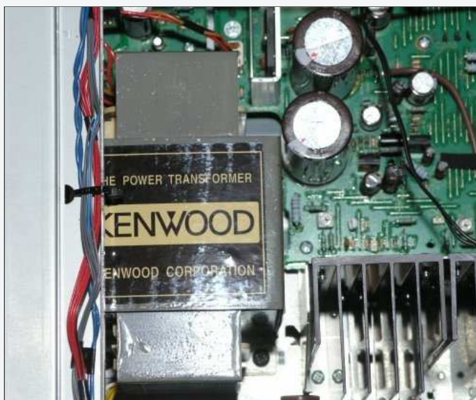
Der am Rande untergebrachte Trafo arbeitet in keiner separaten Kammer
