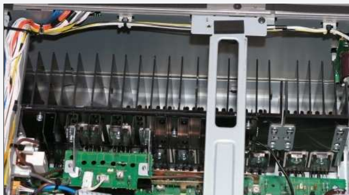
Sehr gut: Kühlkörper aus Aluminium
