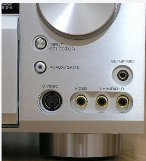
Vergoldeter Front AV-Eingang, leider ohne digitalen Anschluss
