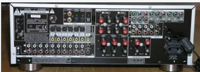
Die Anschlussauswahl ist der Preisklasse angemessen, die Komponentenanschlüsse sind HD-tauglich
