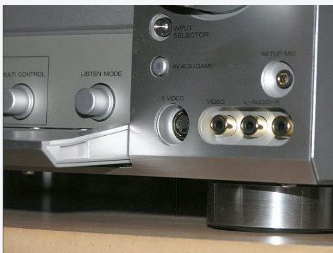
Dicke Standfüße, die Klappe, unter der sich die weniger oft verwendeten Bedienelemente befinden, ist immerhin mit Alu beplankt. Der Kern besteht aus Kunststoff
